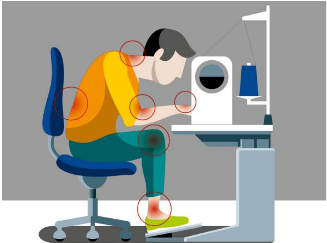
Abbildung X: Nicht-ergonomischer Näharbeitsplatz mit Kennzeichnung der Bereiche erhöhter gesundheitlicher Gefährdung. Quelle: DGUV: Ergonomie an Näharbeitsplätzen. 142
